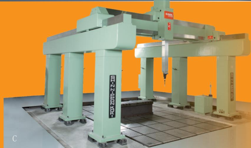
**硬軌** 機種為了達成及確保機械的長期剛性與精度，鑄件須經長期自然消除應力，而後採用SNK五面加工機做一二次精密加工，再使用大型三次元量測儀器做精密檢驗，所有主件皆採用米漢納鑄鐵、高剛性鑄件材質，吸震效果絕佳、耐磨性特強，每一座能提供製造硬軌基座之結構體，皆是經千錘百鍊方能成就。
